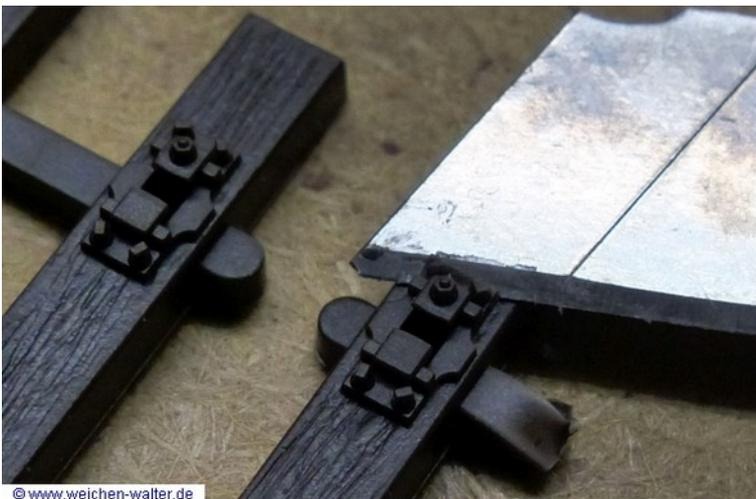
Die Abbindezeit des Klebers kann genutzt werden um die Kleineisen mit einem Abbrechklingenmesser von dem Schwellenrost zu lösen.
