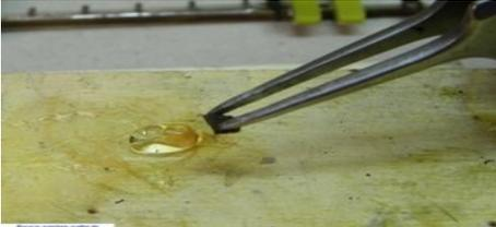
an einem Tropfen Sekundenkleber Gel leicht mit Kleber benetzt
