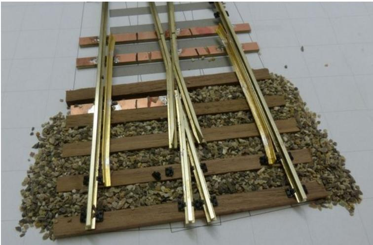
Anschließend wird die Weiche eingeschottert. Dabei werden auch die Lötswellen abgedeckt.
