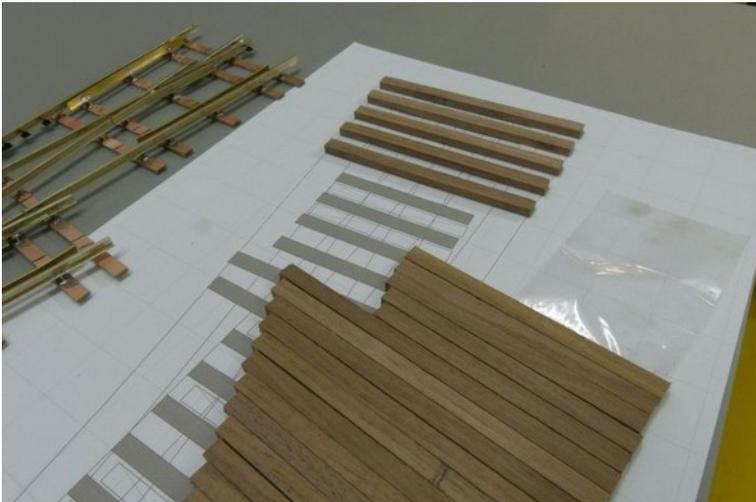
Der Schwellenplan wird auf das Trasse und anschließend die Holzschwellen auf den Schwellenplan geklebt
